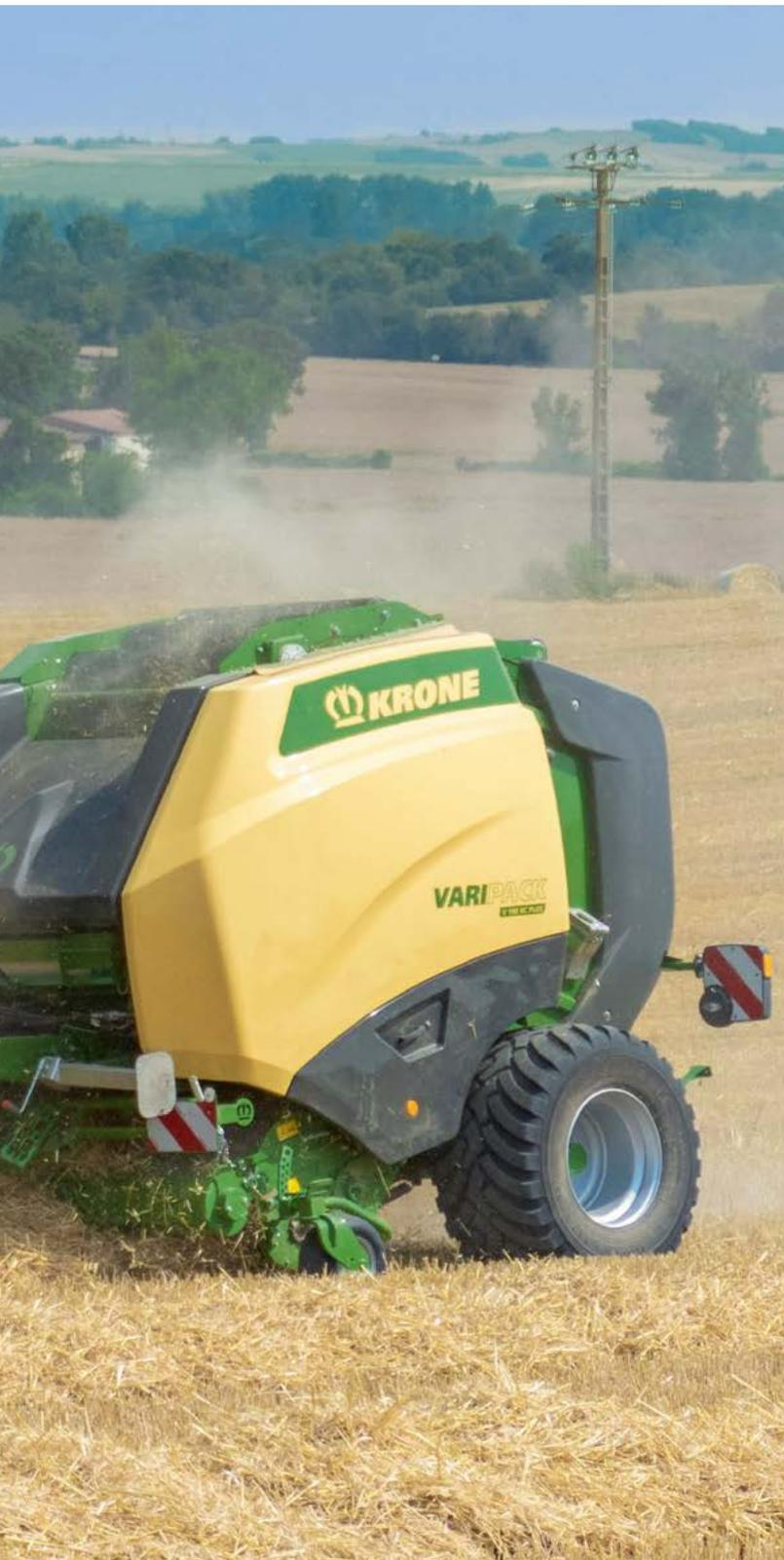
Die KRONE VariPack Plus ist für den Einsatz in trockenen Erntegütern entwickelt worden. In der VariPack Plus wird einfache Technik mit hohen Durchsätzen und Pressdichten vereint.
